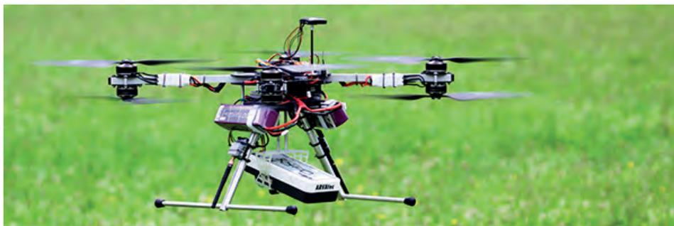
Dron con sensores espectrales para monitorizar el cultivo. / AgLeader-AAMS.
